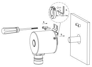
Alle beweglichen Justierelemente müssen in axialer und radialer Richtung Spiel haben, um Verschiebungen durch Temperatur und mechanisches Spiel auszugleichen. Befestigungsschrauben bzw. Schrauben des Klemmrings fest anziehen. Die Drehmomentstütze darf ausser an den Befestigungspunkten des Drehgebers und Motors nicht anstehen.
